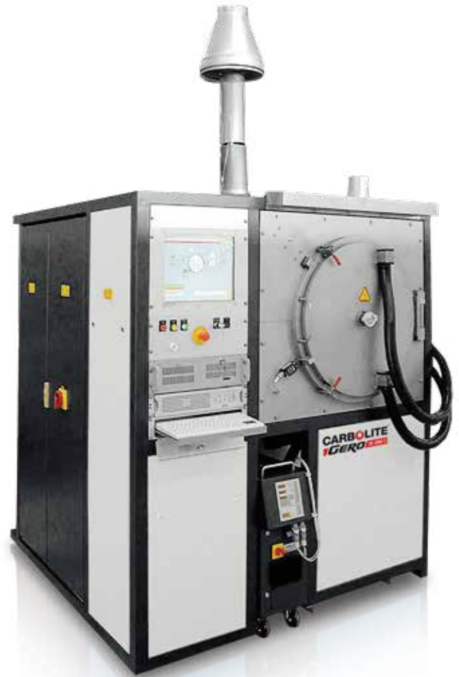
EBO 120/1.5: 有效空间120升排胶炉，最高温度150摄氏度。工作温度120摄氏度。气化的硝酸和氮气通入炉膛，用于催化排胶。
