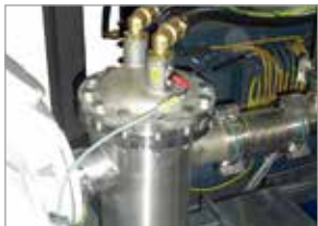
热交换器，用于冷却炽热的气氛
