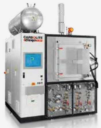
HTK 25 W/22: 高温箱式炉的可用体积为25L，最高可达2200°C，通过触摸屏自动操作。
