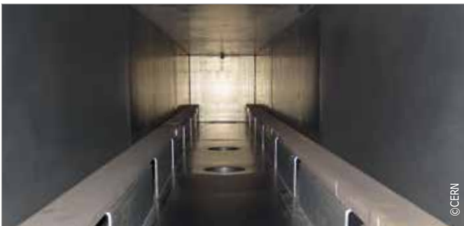
用于生产超导线圈的7米长的气密炉内胆。
