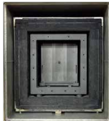
HTK 8 GR/ 22:箱式炉，可用体积8L，温度2200°C。石墨保温材料由多层隔热板组成。加热盒里面有一个反应罐，位于中心位置。
