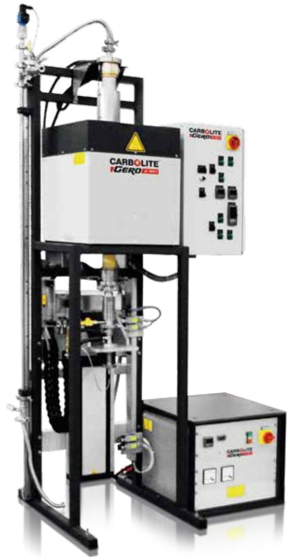
BV-HTRV 70-250/18：布里奇曼晶体生长炉，加热长度250mm，最高温度1800摄氏度。图示系统装有初级真空泵。
