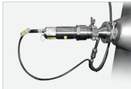
高温计测量最高温到3000°C。高温计聚集于热区里的一个点，热辐射通过石英玻璃传导再由高温计的传感器测量到。高温计是由滑动热电偶控制的。气体管确保气流沿着石英窗通过。
