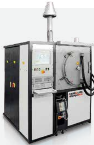
EBO 120/1.5: 排胶炉的体积可为120L，温度达150°C。工作温度120°C。硝酸被雾化后，与氮气混合通入炉膛，用于催化排胶。
