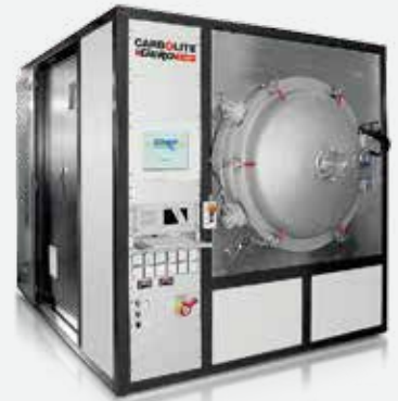
PDS 120 Mo/14: 有分压功能的炉，有效容积120升，最高1450°C。PSD炉可用于排胶和烧结。
