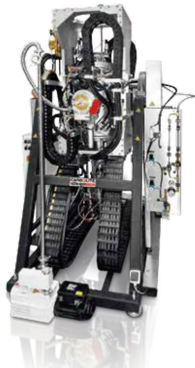
KZA-V 40-400/16-1G：布里奇曼晶体生长炉温度可达1600°C，加热长度为400mm。三区控温，石墨加热元件，可在真空环境或者惰性气氛下全自动运行，并有数据记录。
