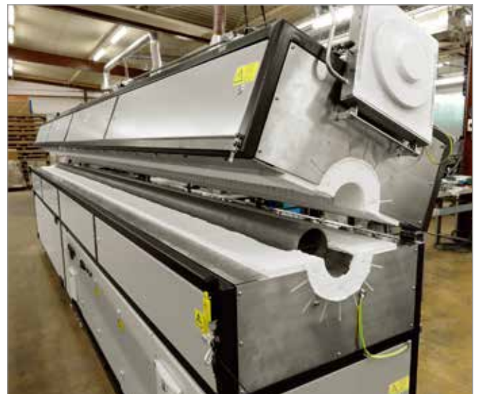
翻开式管式炉，加热长度5.5米，温度1000°C
