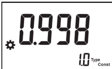
图 5-7 电极类型 1.0，电极常数 0.998 显示示意图
