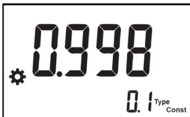
图 5-8 电极类型 0.1，电极常数 0.0998 显示示意图
