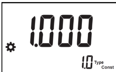
图 5-6 电极类型 1.0，电极常数 1.000 显示示意图
